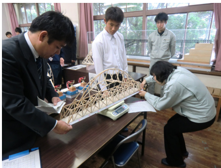
形状測定と重量測定の様子
