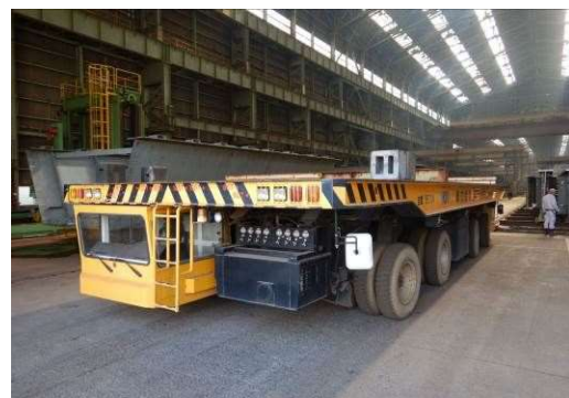
自重 55 t、最大積載量 120 t の台車
